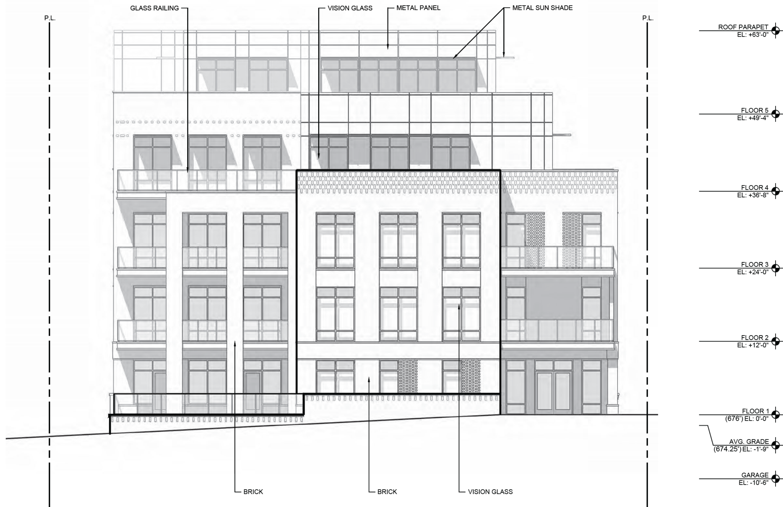
1 SOUTH ELEVATION SCALE: 1/8" = 1'-0"
